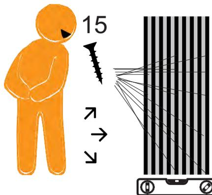
Mit Schrauben oder Kleber werden die Akustikplatten an der Wand montiert. Bei der Montage an der Decke müssen immer Schrauben verwendet werden.
