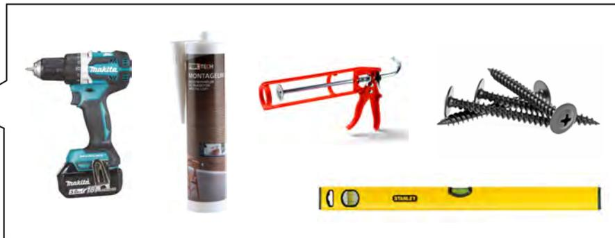
Sie benötigen Kleber und eine Kleberpistole, eine Wasserwaage, einen Bleistift, einen Akkuschauber und schwarze FibroTech-Schrauben. Benutzen Sie gerne Baumwollhandschuhe bei der Installation.
